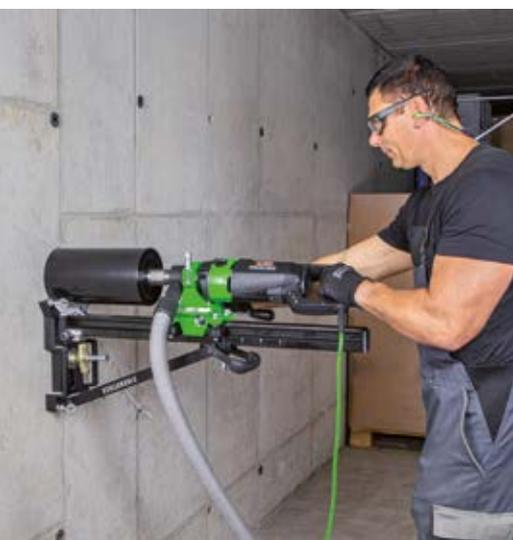
Die neue Softschlag-Kernbohrmaschine ESD 162 von Eibenstock im Einsatz mit dem passenden Bohrständer BST 162 H. (Foto: Eibenstock)
