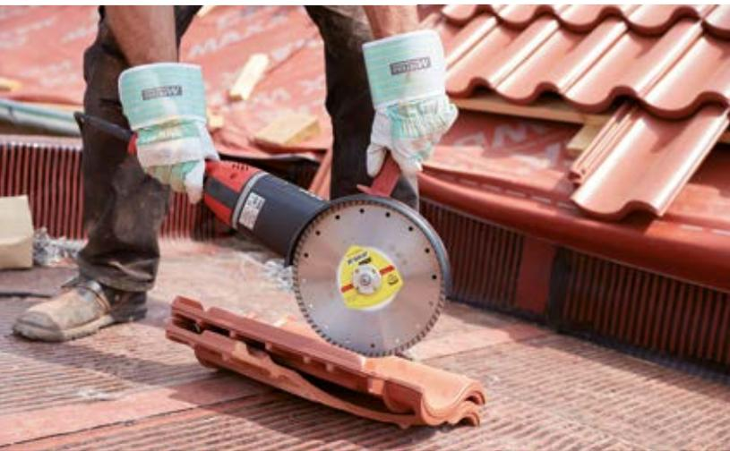
Die Diamanttrennscheiben mit geschlossenem Rand verhindern ein Ausbrechen der Ränder beim zu trennenden Material und sorgen so für perfekte Schnittkanten.
